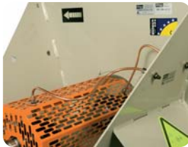
Engrasadores externos para facilitar el mantenimiento
