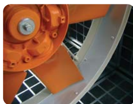
CJTHT/ATEX: Banda de aluminio para prevenir chispas según norma EN-14986:2006
