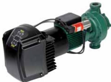
Bomba de circulación para agua caliente o fría con conexiones en línea, diseñada para instalarse directamente sobre la tubería en sistemas civiles e industriales de calefacción, acondicionamiento, refrigeración y agua sanitaria. Extremadamente versátil gracias a la utilización del inverter **MCE/C**, que garantiza una adaptación automática de las prestaciones de la bomba en función de las diferentes necesidades de la instalación manteniendo al mismo tiempo la presión diferencial constante.
